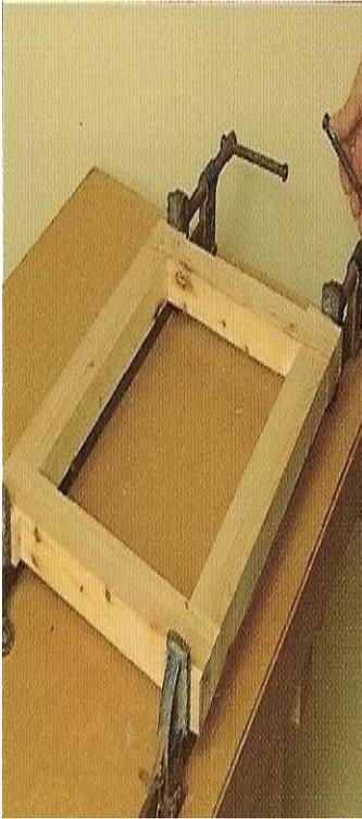
Se usan tacos de madera de desperdicio con las mordazas para evitar que éstas se deterioren o marquen, para mantener el escuadrado se alinean el centro de la mordaza con el del grueso de la madera.
