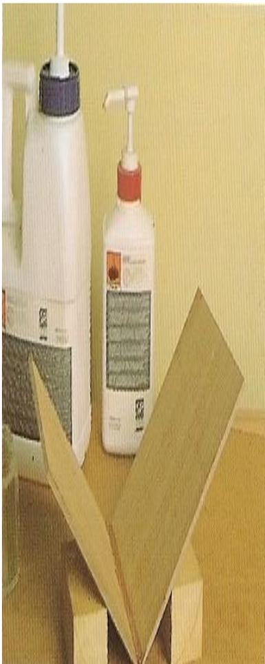
Las resinas epoxi son adhesivos de dos componentes (resina y endurecedor) que deben mezclarse según las normas del fabricante.
