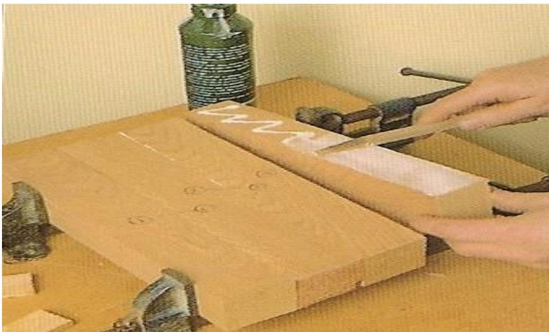
Se preparan las piezas a medida por separado, y una vez que estén listas se montan en dos cárceles para comprobar su alineación, a esto se le llama montaje en seco y es indispensable para las operaciones de ensamble y sujeción. Se recomienda numerar las piezas con marcas de posición para asegurarse de su perfecta alineación.
