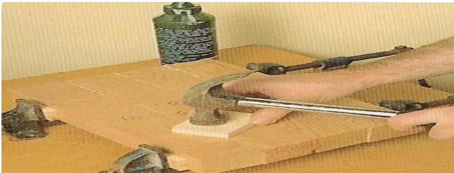
Se usan el martillo y un taco de madera de desperdicio para alinear las dos piezas antes de aplicar la presión de amordazado final.
